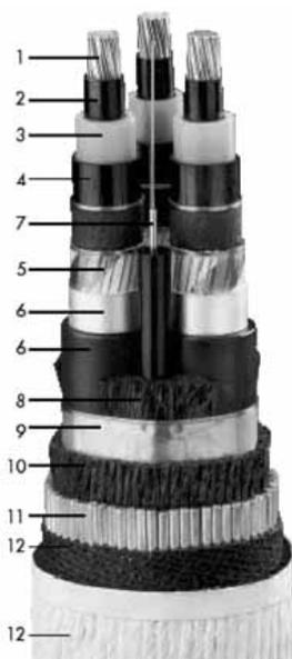
Figura 26, Cavo subacqueo isolato in XLPE: l'isolante circonda singolarmente i conduttori; al centro si nota il cavetto fibra ottica ed in basso, l'armatura in fili di acciaio
